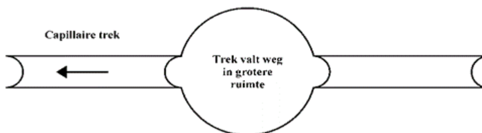
Figuur 5.5 Luchtbelletje en onderbroken capillair.
